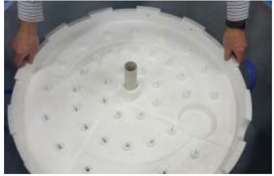
Ylimmän vedenjakolevyn asentaminen
